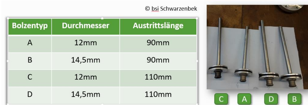
Abbildung 10: Bolzen verschiedener Durchmesser und Austrittslängen (Firma Jarvis) wurden an der in AP4 an 1459 weiblichen Tieren eingesetzt.
