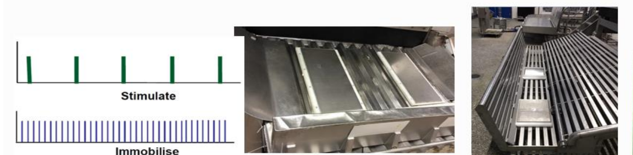
Abbildung 14: Verfahren zur Elektroimmobilisierung stark schlagender Tiere mittels in den Auswurfrost integrierter Plattenelektroden (System Stim Tech, Abato NL).
