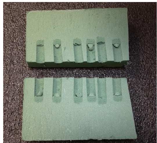
Abbildung 3: Annäherungsmessung zur Austrittslänge mittels Blumensteckschaum.
