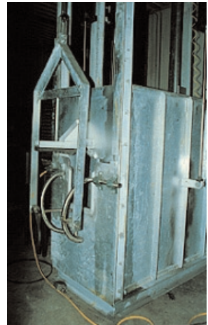
Abbildung 2: Die ASPCA-Falle ist eine ausgereifte Fixierungseinrichtung für rituelle Schlachtungen in aufrechter Position (weitere Informationen, siehe: www.grandin.com )
