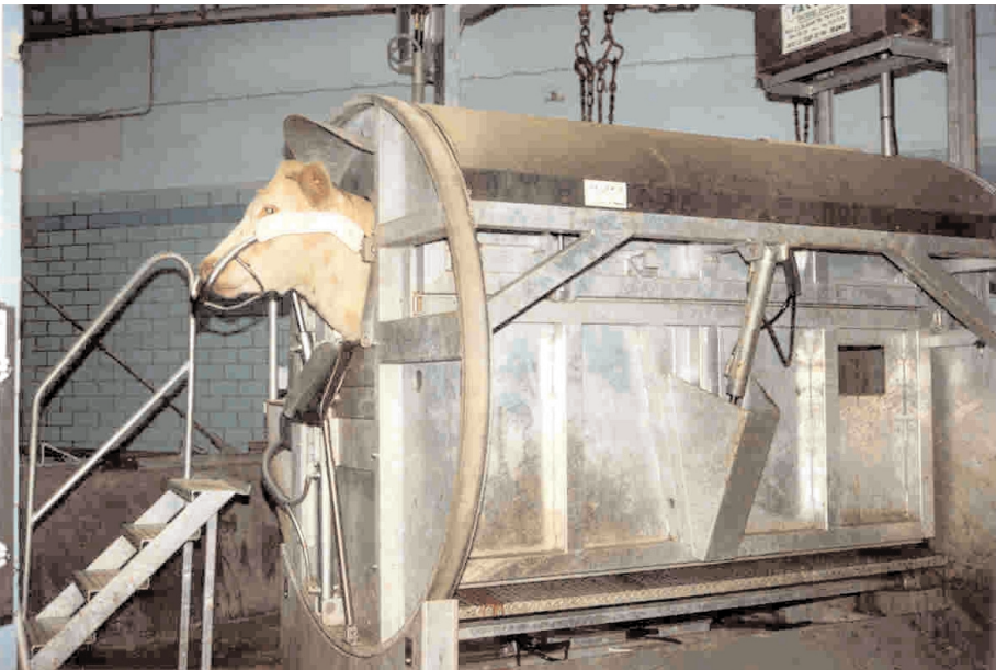
Abb. 1: Weinberg'scher Apparat, in dem rituelle Schlachtungen und eine Betäubung nach dem Schlachtschnitt (post cut stunning) durchgeführt wurden
